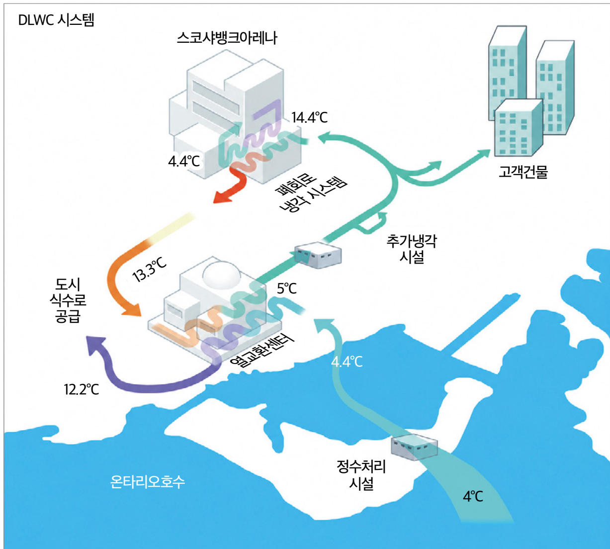
<그림 4> DLWC(Deep Lake Water Cooling, 심층 호수수 냉각 시스템)
