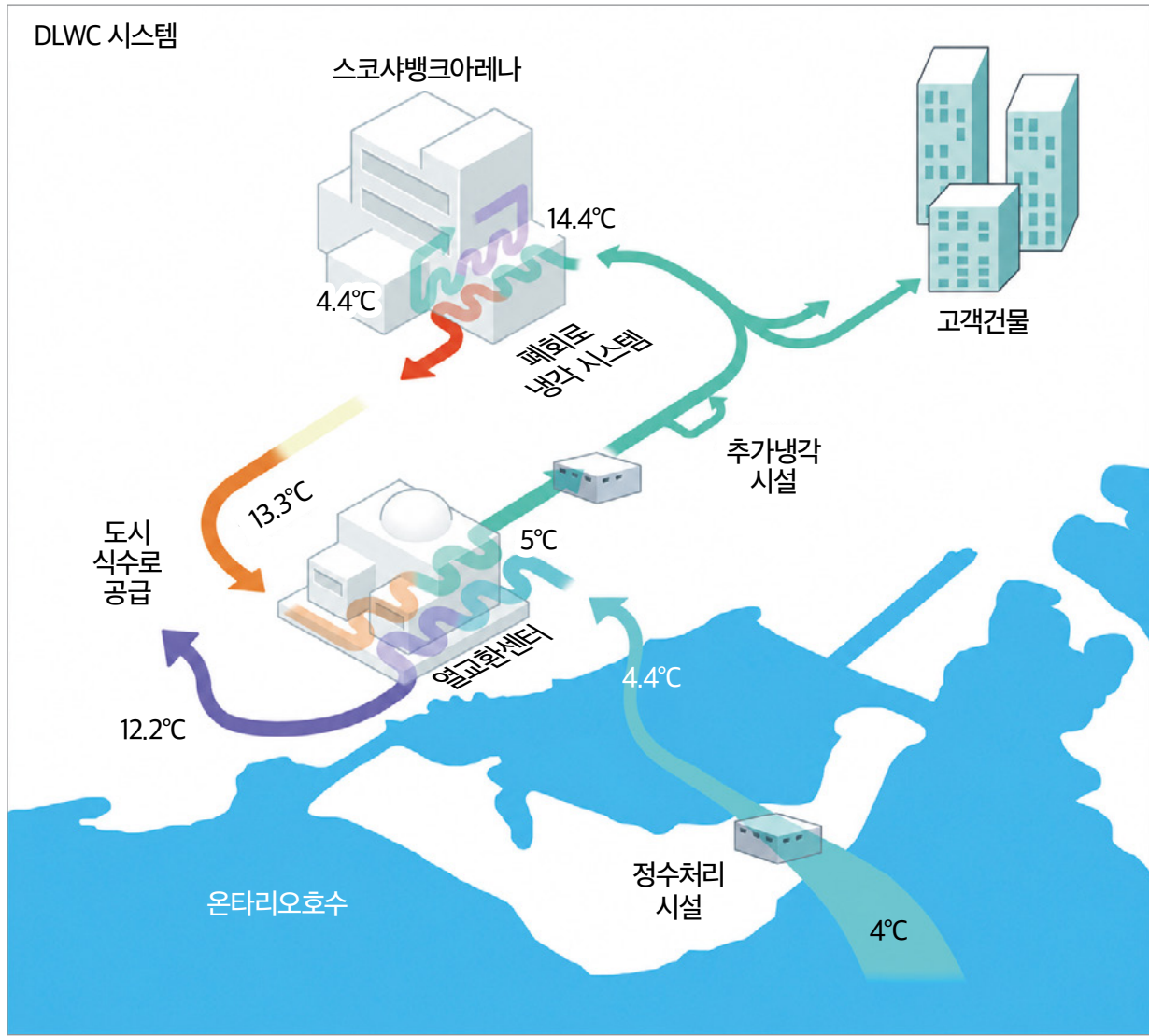
<그림 4> DLWC(Depth Lake Water Cooling, 심층 호소수 냉각 시스템)
